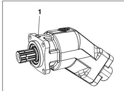
Abb. 14: Inspektionsbohrung
