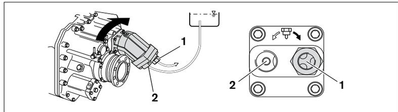
**Abb. 10: Druckstutzen bei Auslieferung – für Drehrichtung Nebenabtrieb rechts (= Drehrichtung Pumpe links)**
