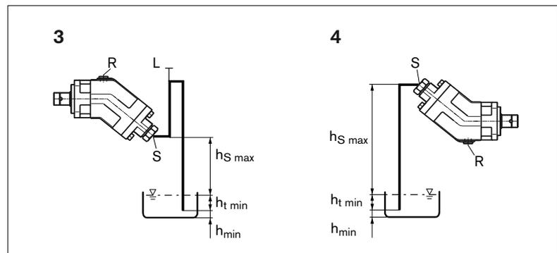
Abb. 9: Übertankeinbau mit Einbaulage 3–4
