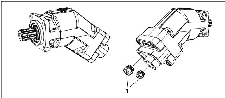
Abb. 1: Axialkolbeneinheit
