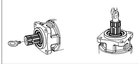
Abb. 5: Befestigung der Ringschraube
