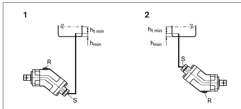
Abb. 8: Untertankeinbau mit Einbaulage 1-2
