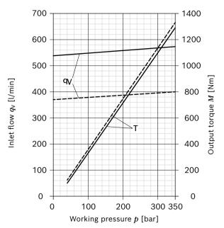
*n* = 2200 rpm - - - - · *n* = 1500 rpm
